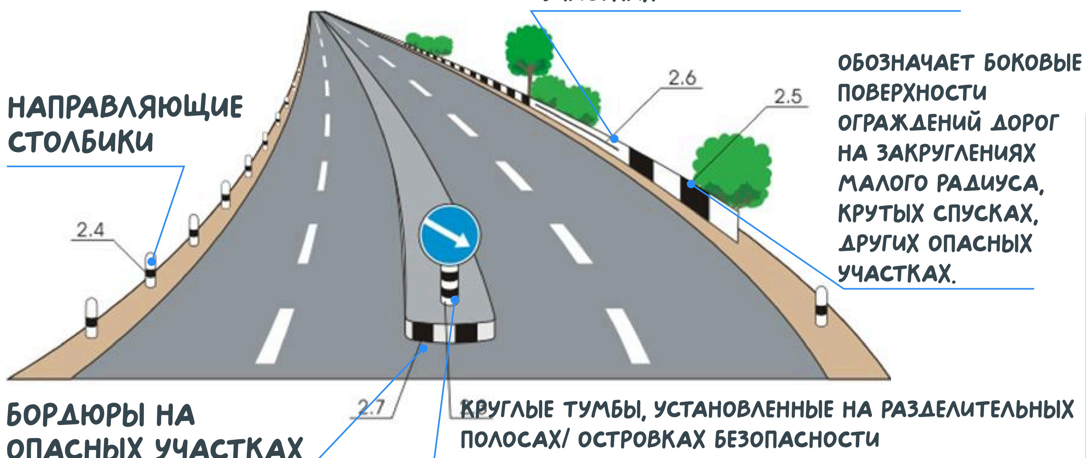
ОБОЗНАЧАЕТ БОКОВЫЕ ПОВЕРХНОСТИ ОГРАЖДЕНИЙ ДОРОГ НА ЗАКРУГЛЕНИЯХ МАЛОГО РАДИУСА, КРУТЫХ СПУСКАХ, ДРУГИХ ОПАСНЫХ УЧАСТКАХ.
